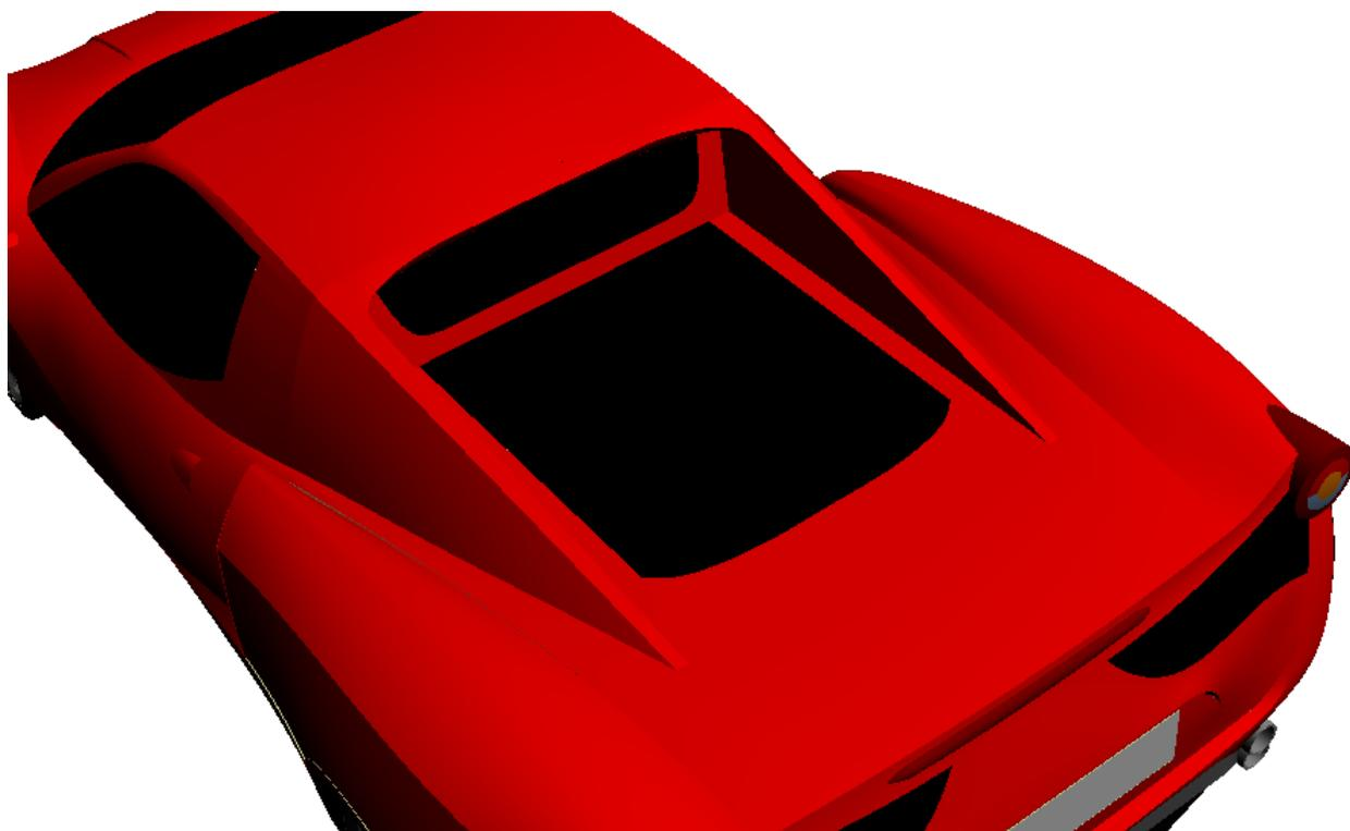
Figura 3.3: modellazione finale della copertura del vano motore
